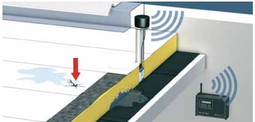
Abb. 3.10.1 Funktionsprinzip der Leckageortung durch eingebaute Sensoren
